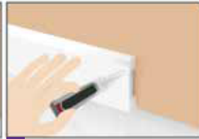
4. Utiliza pegamento instantáneo en las uniones de las juntas.
