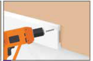
5. Si deseas utilizar clavos evita colocarlos en la ranura de atrás de los perfiles.
