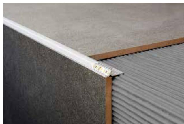
1. Aplica adhesivo sobre la superficie donde deseas instalar el perfil, luego coloca el revestimiento sobre el ala de enganche perforada en forma de "A" y presiona el perfil contra la pared/muro hasta que el adhesivo sobresalga por las perforaciones.
