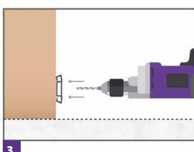
3. Presenta el clip de fijación en la altura marcada y realiza un agujero en el centro del clip hasta perforar la pared/muro.
