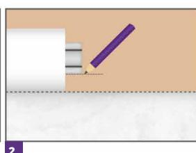
2. Presenta el perfil en la pared/muro dejando que el clip de fijación sobresalga del extremo del mismo y marca la altura.
