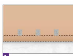
6. Repite esta secuencia cada 40 cm dejando una distancia no menor a 25 cm de los extremos. En paredes/muros de madera puedes utilizar un clavo y un martillo manual o neumático para fijar los clips.
