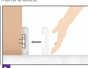
7. Presiona el zócalo/guardapolvo/guardaescojas sobre los clips de fijación hasta que quede firme.
