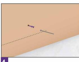
4. Inserta un tarugo en el agujero de la pared/muro y atornilla el clip de fijación.
