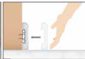
7. Presiona el zócalo sobre los clips de fijación hasta que quede firme.
