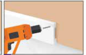
5. Si deseas utilizar clavos evita colocarlos en la ranura de atrás de los perfiles.
