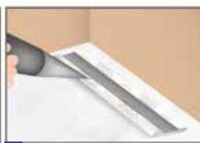
2. Aplica abundante pegamento (adhesivo PRO-FIX®, silicona neutra o cemento de contacto sin solvente) en la parte posterior del zócalo/contramarco.
