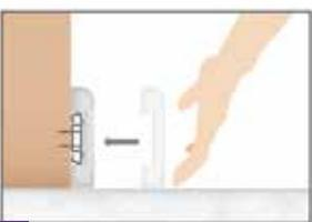
7. Presiona el zócalo/contramarco sobre los clips de fijación hasta que quede firme.
