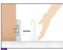
7. Presiona el zócalo sobre los clips de fijación hasta que quede firme.
