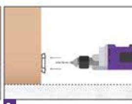
3. Presenta el clip de fijación en la altura marcada y realiza un agujero en el centro del clip hasta perforar la pared.
