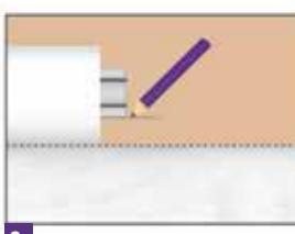
2. Presenta el zócalo en la pared dejando que el clip de fijación sobresalga del extremo del mismo y marca la altura.
